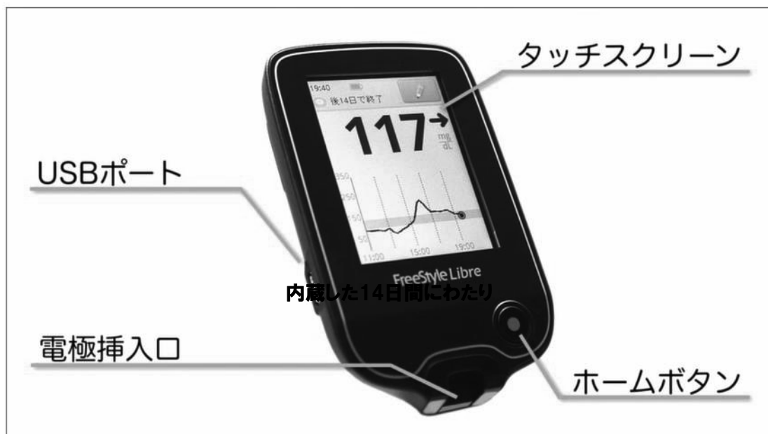
図2. FreeStyleリブレ®リーダーは、センサーが測定した組織間質グルコース値(IGL)を瞬時に表示すると共に、14日間にわたり、5分毎に持続的に測定されたIGLデータをエクセルに記憶し、モニターすることができる。現在は携帯電話に本リーダー機能を持たせることが可能である。
